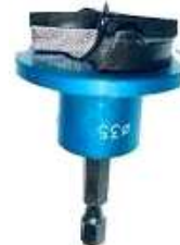
02203.0030.TP Ø - 35 mm. Metal duro Con tope de profundidad taladro de 9 a 13 mm. Embalaje: 1 ud.
