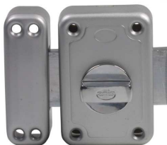
01804.0080 - Cromo mate Cerradura sobreponer pomo (interior) - llave (exterior) Cilindro Ø26 mm, longitud 50 mm, llave de puntos Entrada 33 mm. Dimensiones caja: 66x97 mm. Embalaje: 1 ud.
