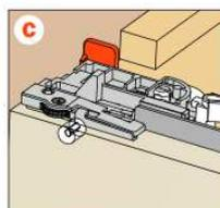
Sistema antivuelco - fijación sobre cajón
