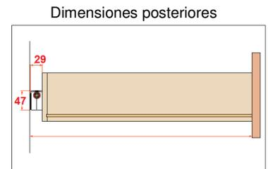
**01002.STAB1** - Kit estabilizador cajón sincronizado (ancho máximo cajón 1300 mm.)
